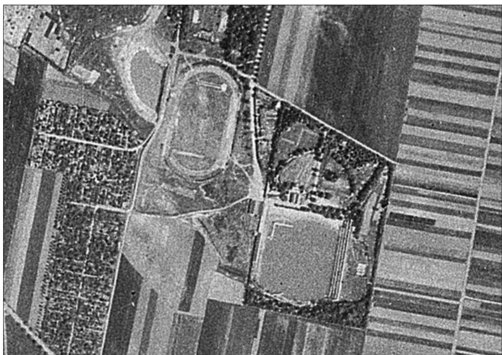
Abb. 16: Luftbild der Bergschadenssituation über dem Grubenfeld Leopoldshall I/III von Mai 1953. Im Vergleich zur Aufnahme von 1945 ist der Schwefelteich deutlich verkleinert.
