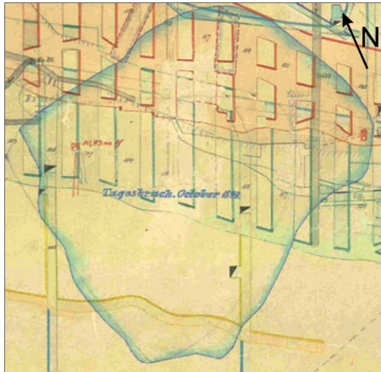
Abb. 7: Ausdehnung und Orientierung des Tagesbruchs „Am Strandbad“ (gefallen am 26.6.1899) über den Grubenbauen der Kali-grube Leopoldshall I/II. Dargestellt ist die Ausdehnung des Tagesbruches im Oktober 1899 über der 2. und 3. Etage.
