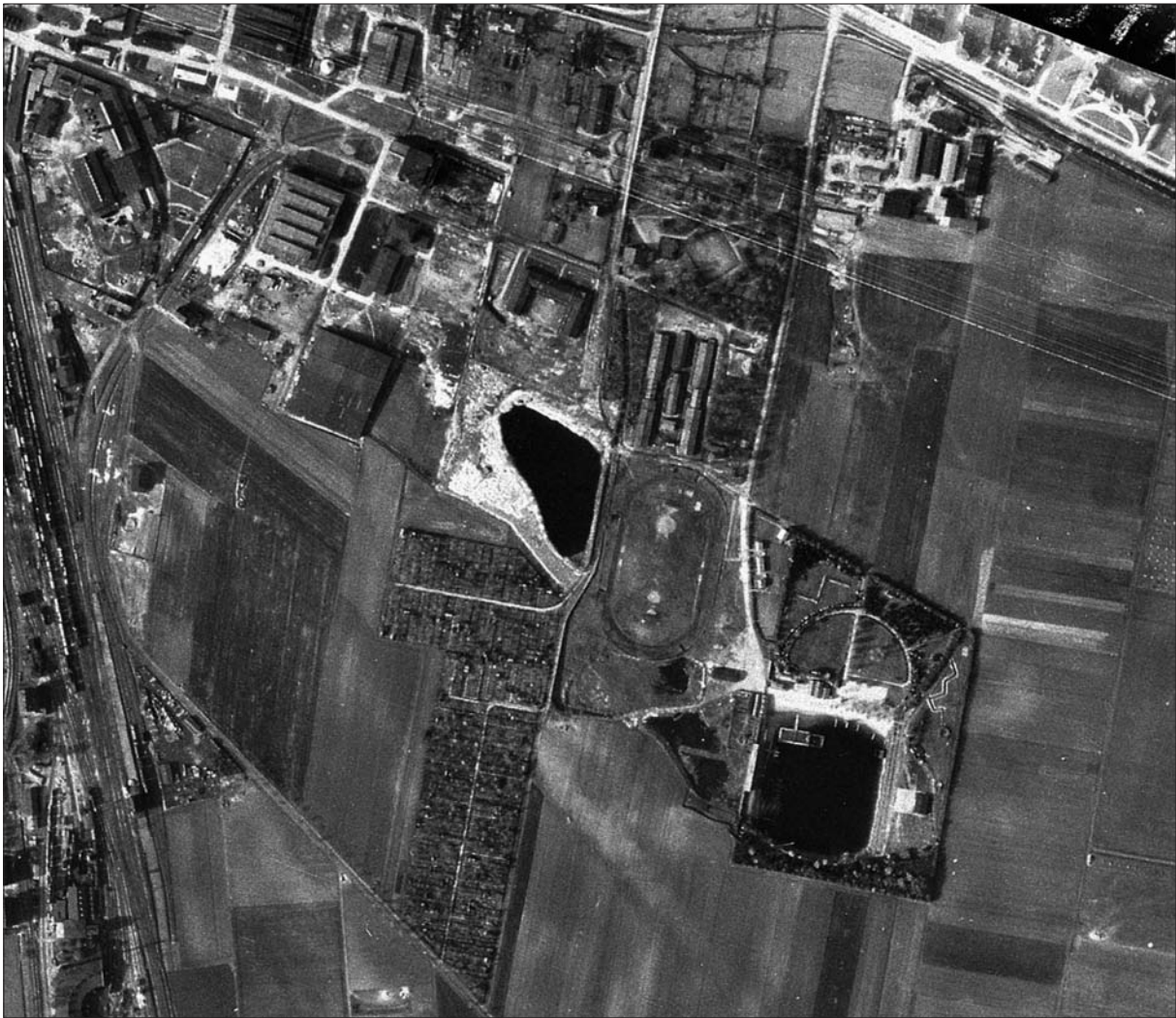
Abb. 15: Luftbild der Bergschadenssituation über dem Grubenfeld Leopoldshall I/III vom April 1945. Deutlich zu erkennen sind das „Strandbad“ sowie der wassergefüllte Schwefelteich.
