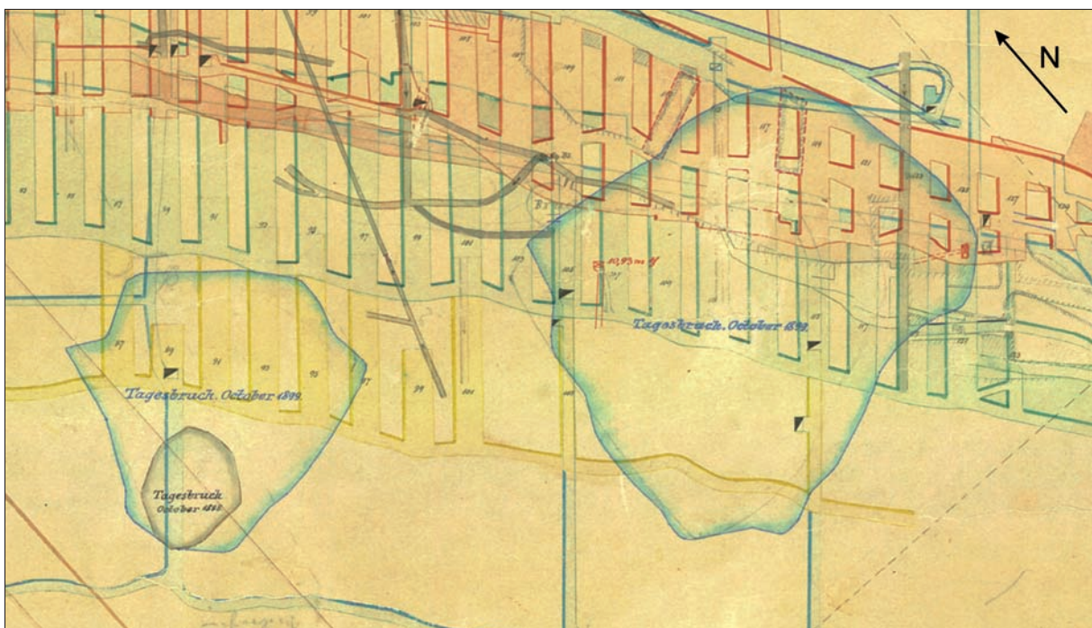
Abb. 6: Abbildung der Tagesbrüche „Am Strandbad“ (1899) und „Parkplatz“ (1898/99) in ihrer Lage zueinander sowie in Bezug auf die Grubensituation unter Tage.
