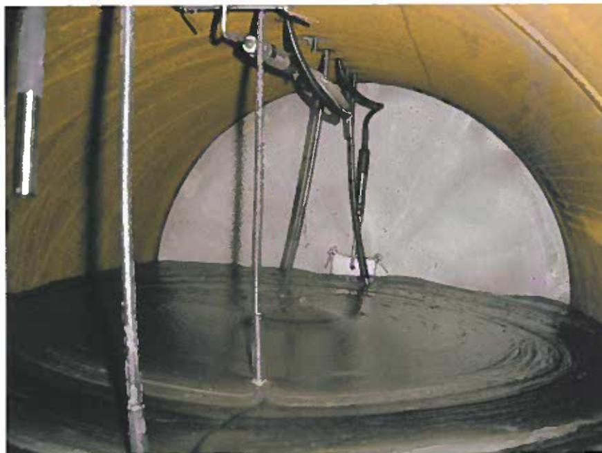
Abbildung 14: Selbstnivellierende Ausbreitung von DBM 2 im kleintechnischen Versuch
