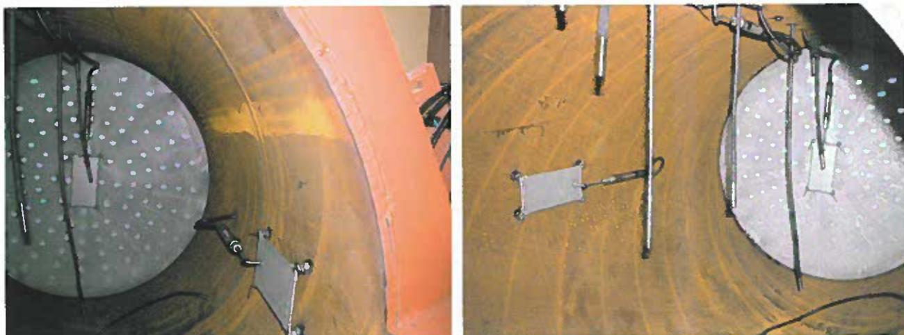
Abbildung 12: Spannungsaufnehmer und Temperaturmessgeber PT 100 der Fa. Glötzl
