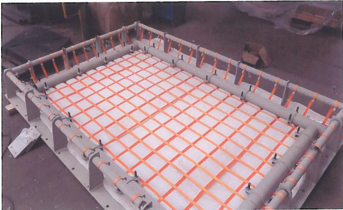
Abbildung STFI 8: Einbau der Abstandsgewirke in die Aufnahmevorrichtung
