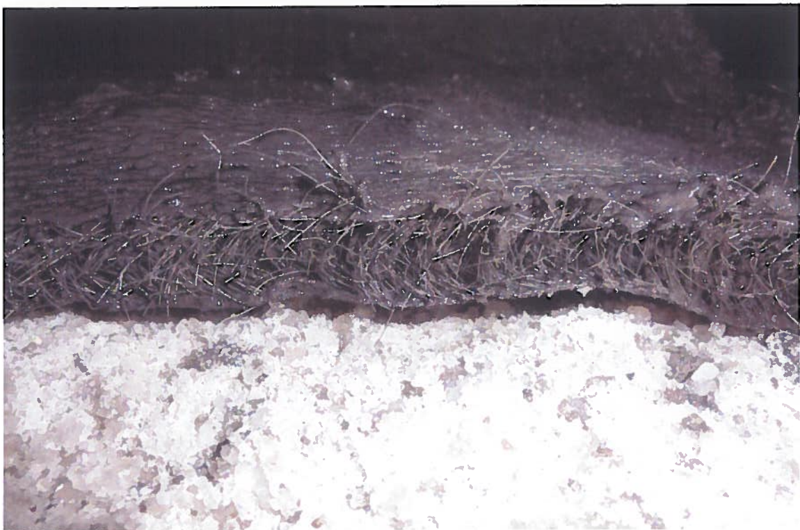
Abbildung STFI 18: Das Innere des Filters wurde nicht versetzt – Salzlauge konnte abfließen
