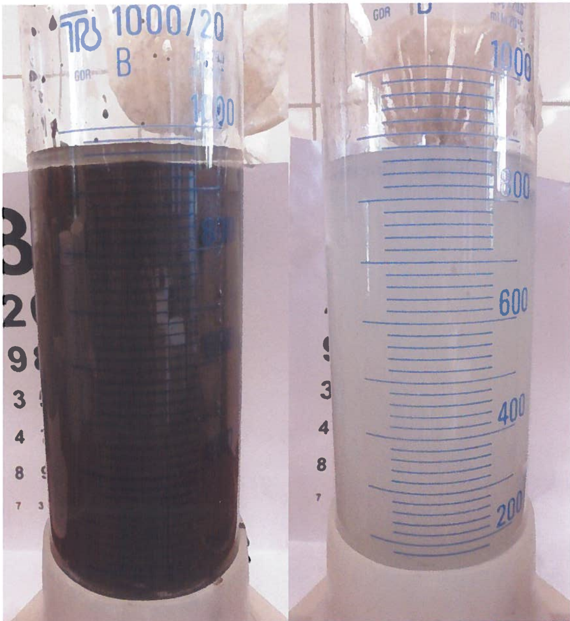
Abbildung K-Utec 18: Filtrat Insituversuch (links: während Bepülung, rechts: nach ca. 30 min.)
