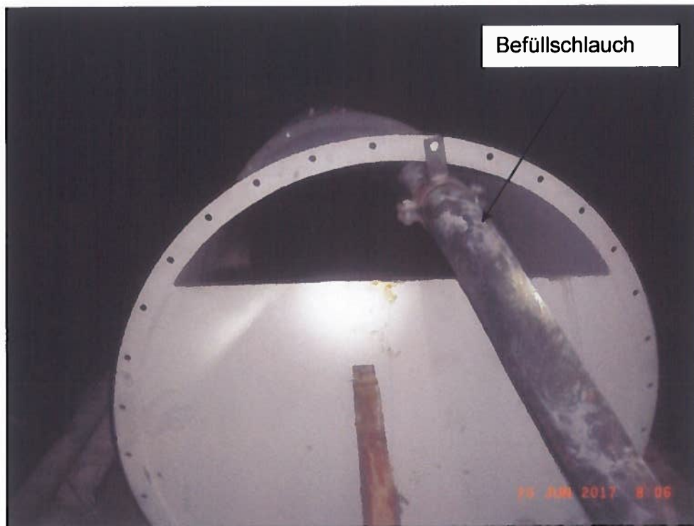
Abbildung KD 18: Befüllen des Versuchsstandes
