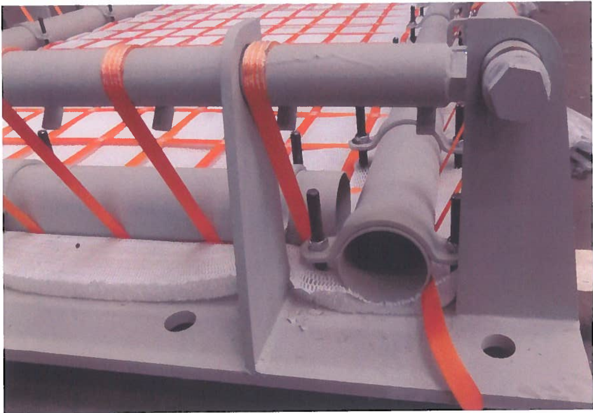
Abbildung STFI 7: Einbau der Abstandsgewirke in die Aufnahmevorrichtung
