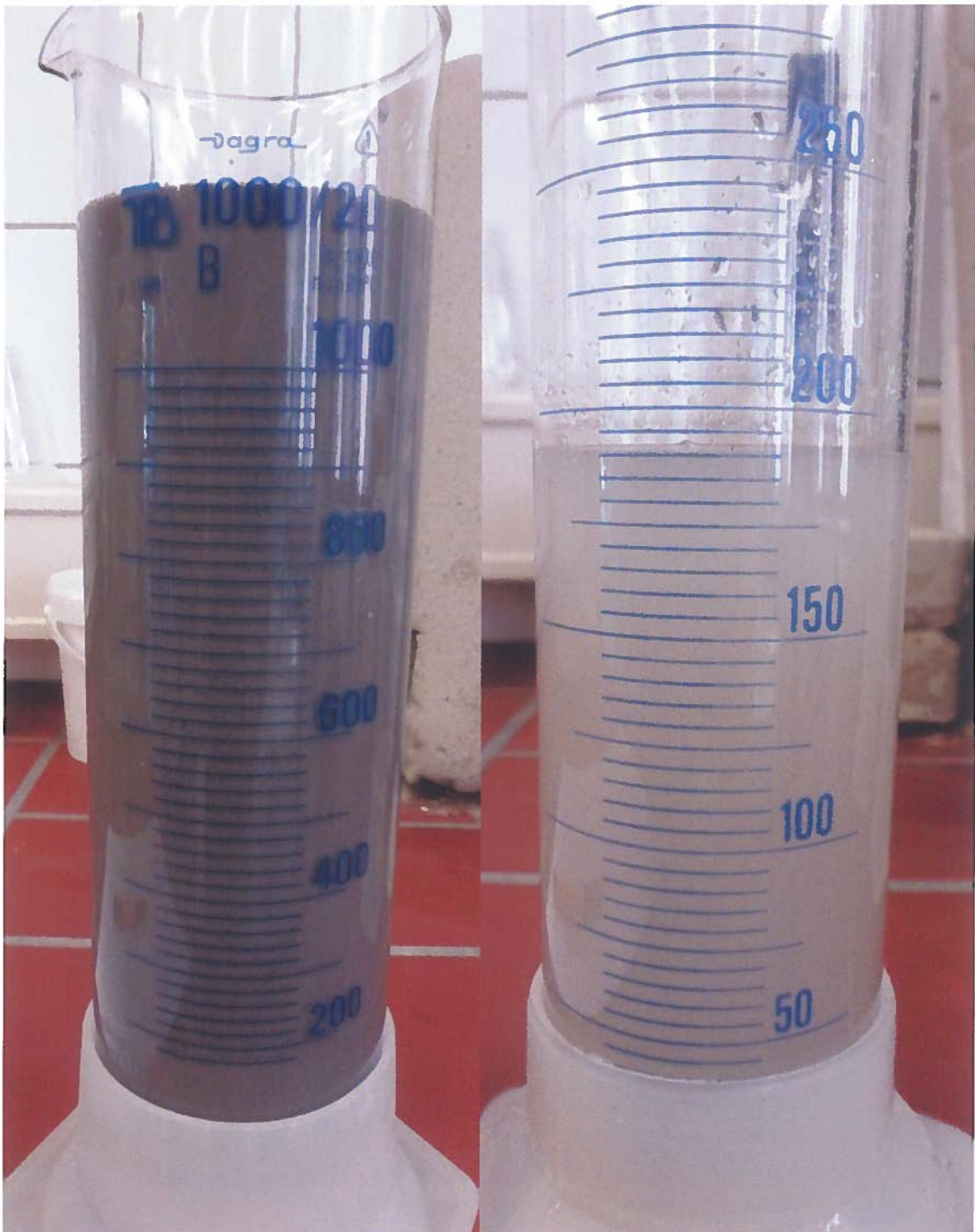
Abbildung K-UTEC 10: Filtrat Technikumsversuch 4 (links nach 15 min., rechts nach 30 min.)
