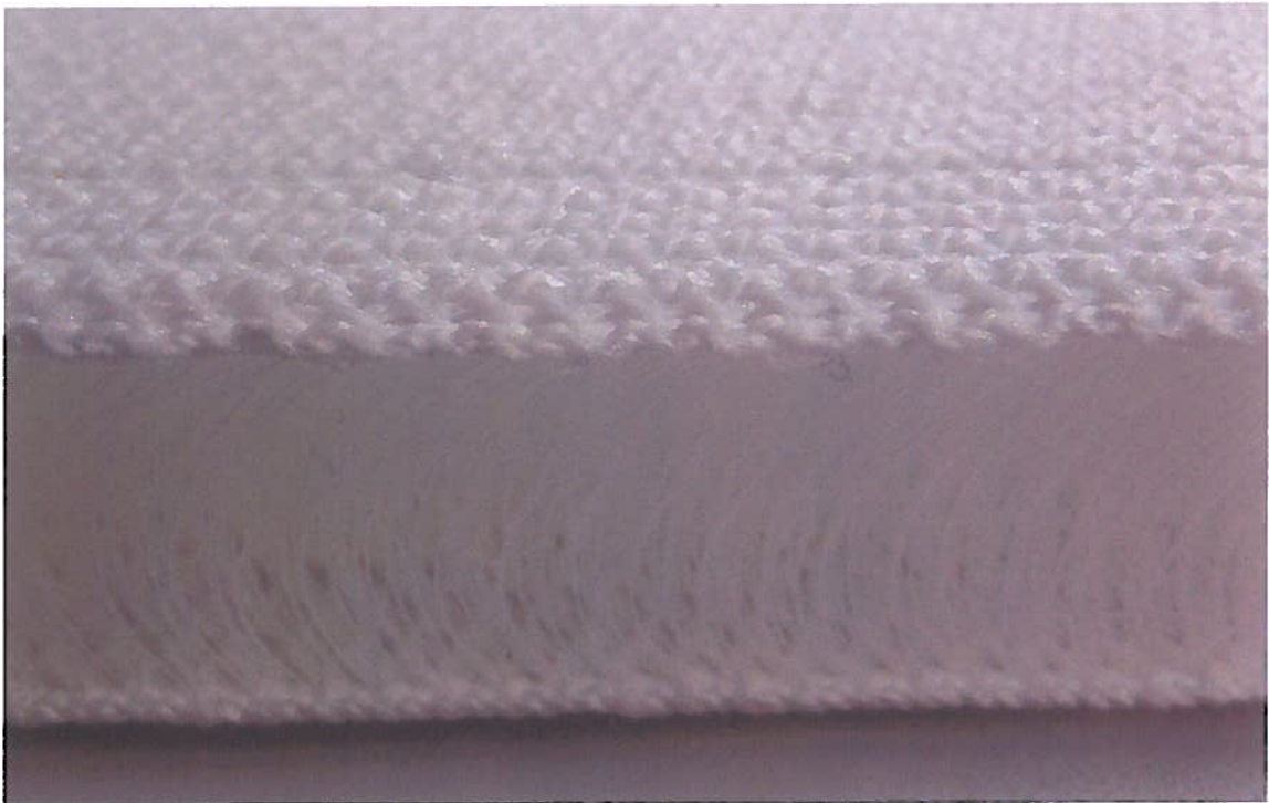
Abbildung STFI 4: Abstandsgewirke zum Einbau als textiler Filter in das Versuchssystem für die Insituversuche unter Tage
