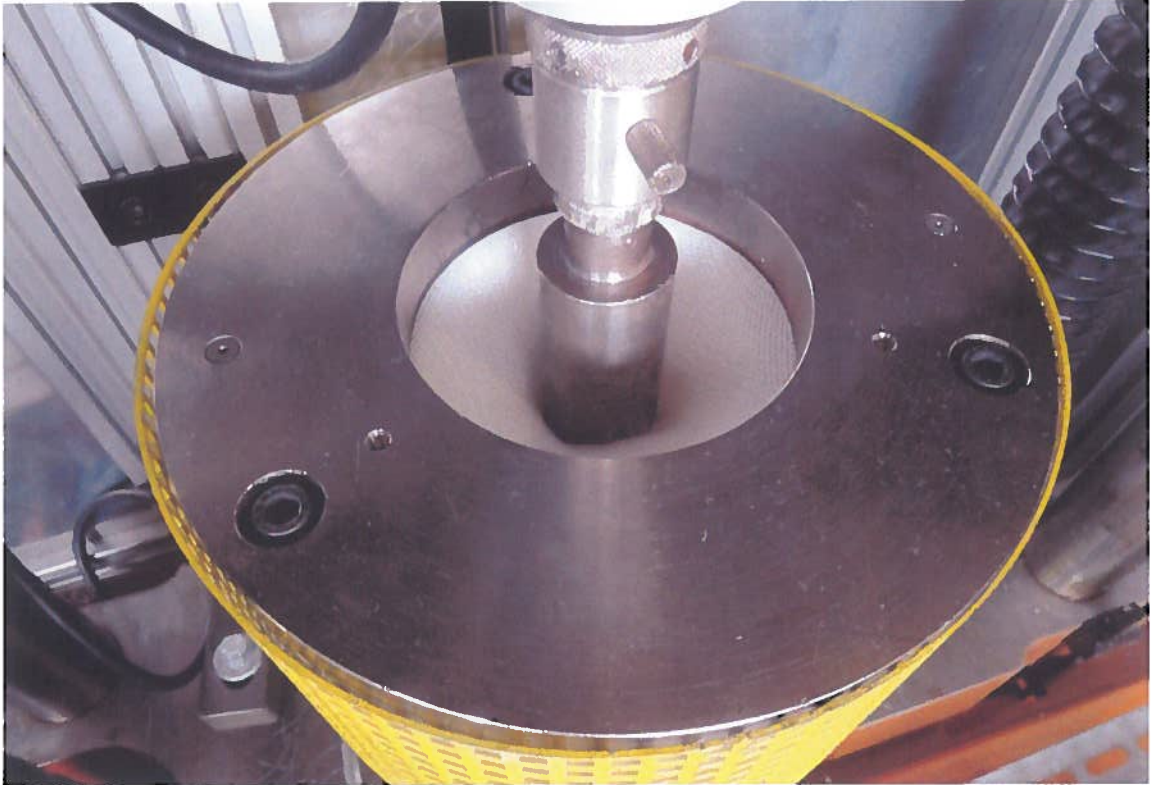
Abbildung STFI 1: Stempeldurchdrückversuch – Versuchsdurchführung
