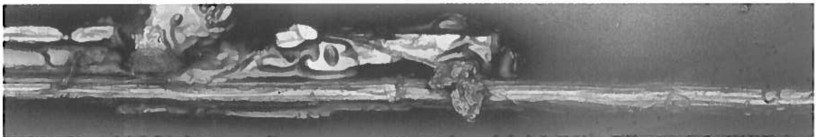
Abbildung TUC 21: Lasermikroskop-Aufnahme Dyneema 3 Monate Lauge
