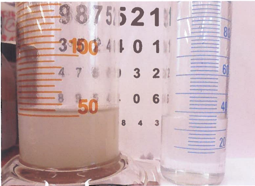
Abbildung K-UTEC 2: gewonnenes Filtrat (links nach 15 min., rechts nach 30 min.)
