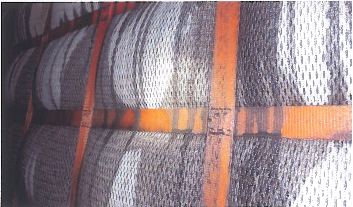
Abbildung STFI 14: Drainagewirkung blieb während der Versuchsdauer erhalten
