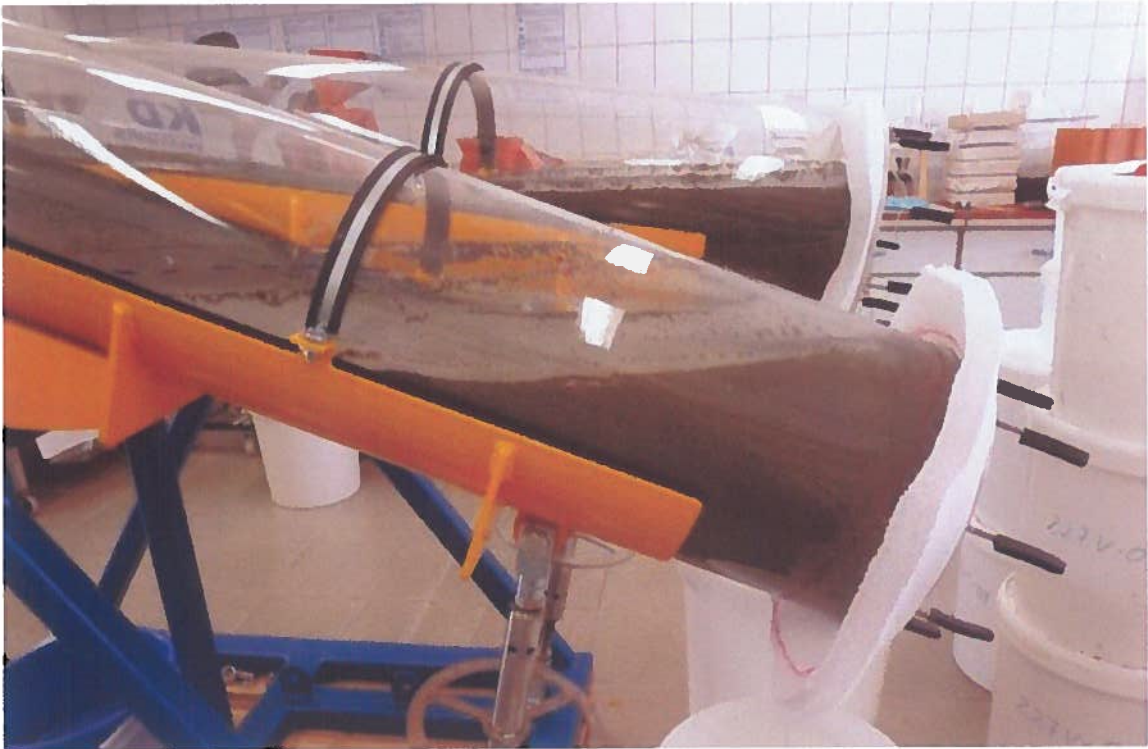
Abbildung STFI 3: Technikumsversuch mit STFI-Filtertextilien beim Projektpartner K-UTEC AG Salt Technologies
