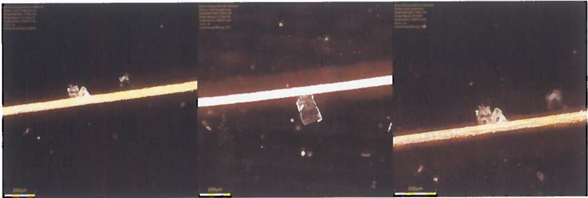
Abbildung TUC 16: Technora-Faser mit Salzkristallen
