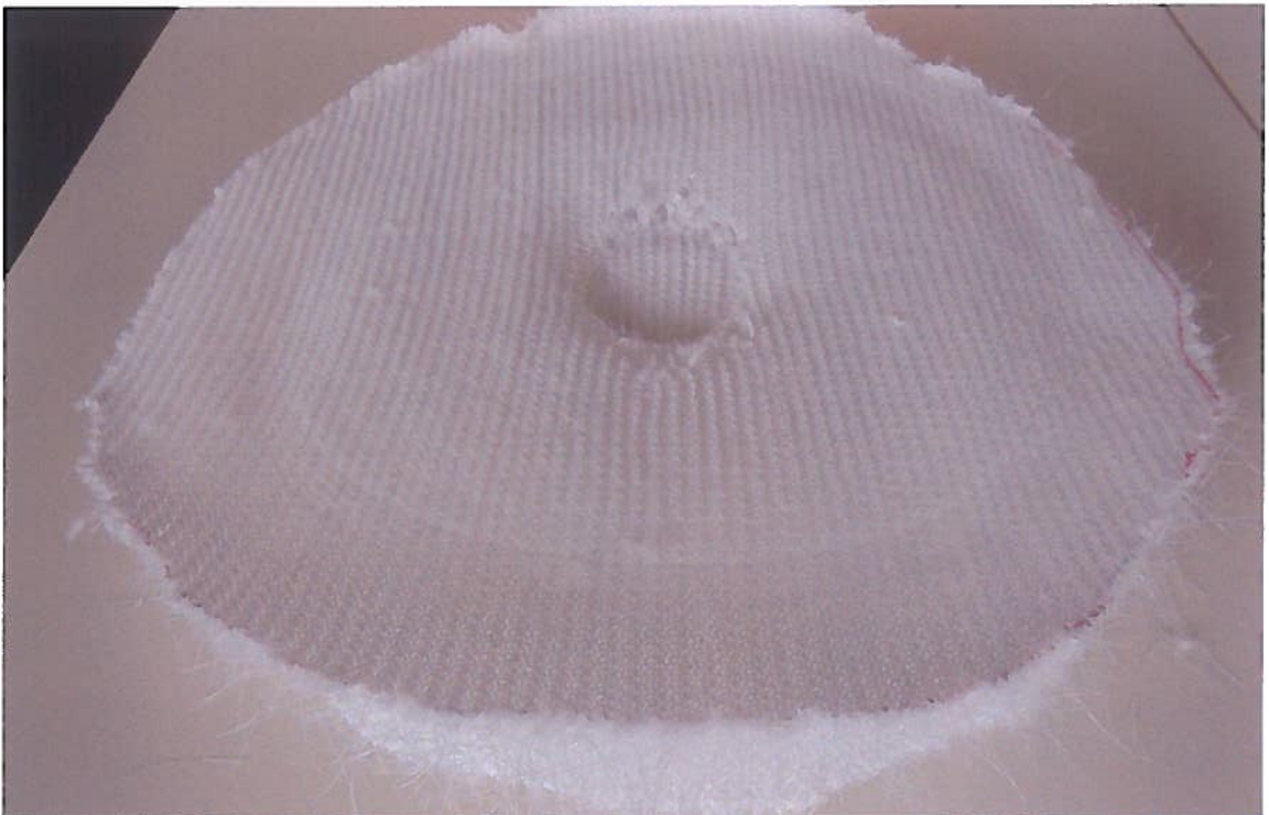
Abbildung STFI 2: Stempeldurchdrückversuch – Probe nach der Prüfung
