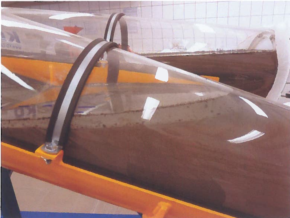
Abbildung K-UTEC 6: Technikumsversuch 3 nach ca. 5 Stunden mit aufstehender Lauge
