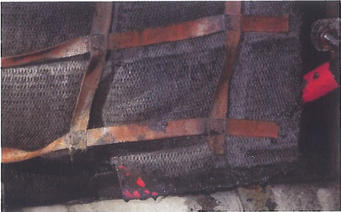
Abbildung STFI 15: Öffnung des textilen Absperrsystems nach Versuchsende
