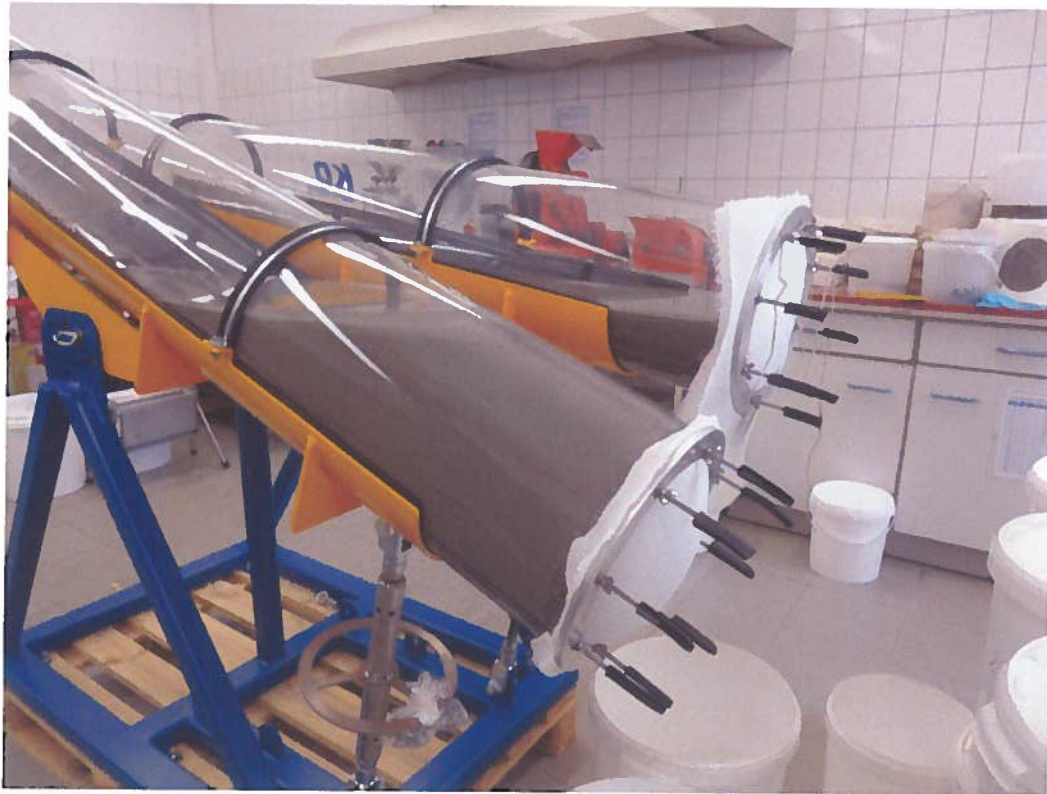
Abbildung KD 8: Befüllung mit Versatzsuspension im Labor von K-UTEC
