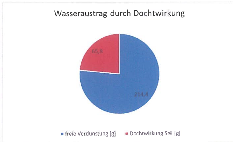
Abbildung TUC 25: Wasseraustrag durch Dochtwirkung
