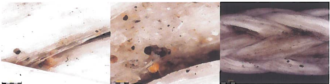
Abbildung TUC 15: Dyneema 6 Monate Suspension
