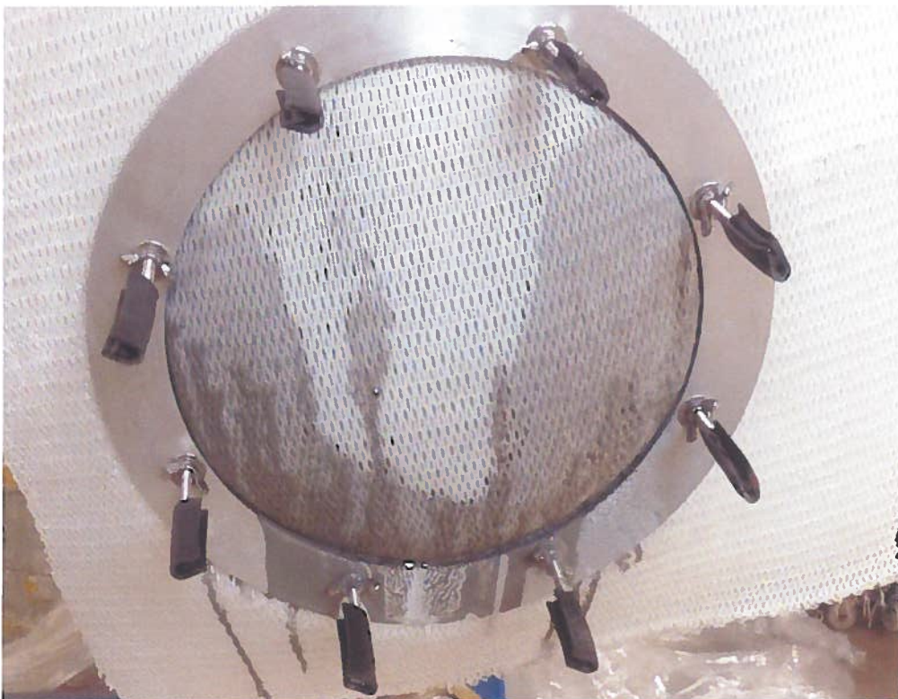
Abbildung K-UTEC 8: Filter nach Beginn des Technikumsversuches 4
