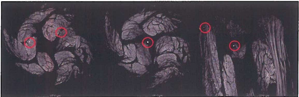
Abbildung TUC 19: CT-Aufnahmen Technora-Seil, 6 Monate Suspension
