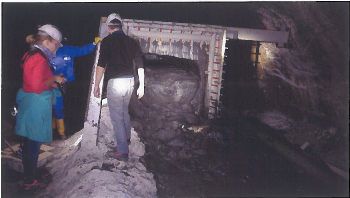
Abbildung KD 25: Versuchsanlage nach der Entnahme Gurtbandnetz und Filtermaterial
