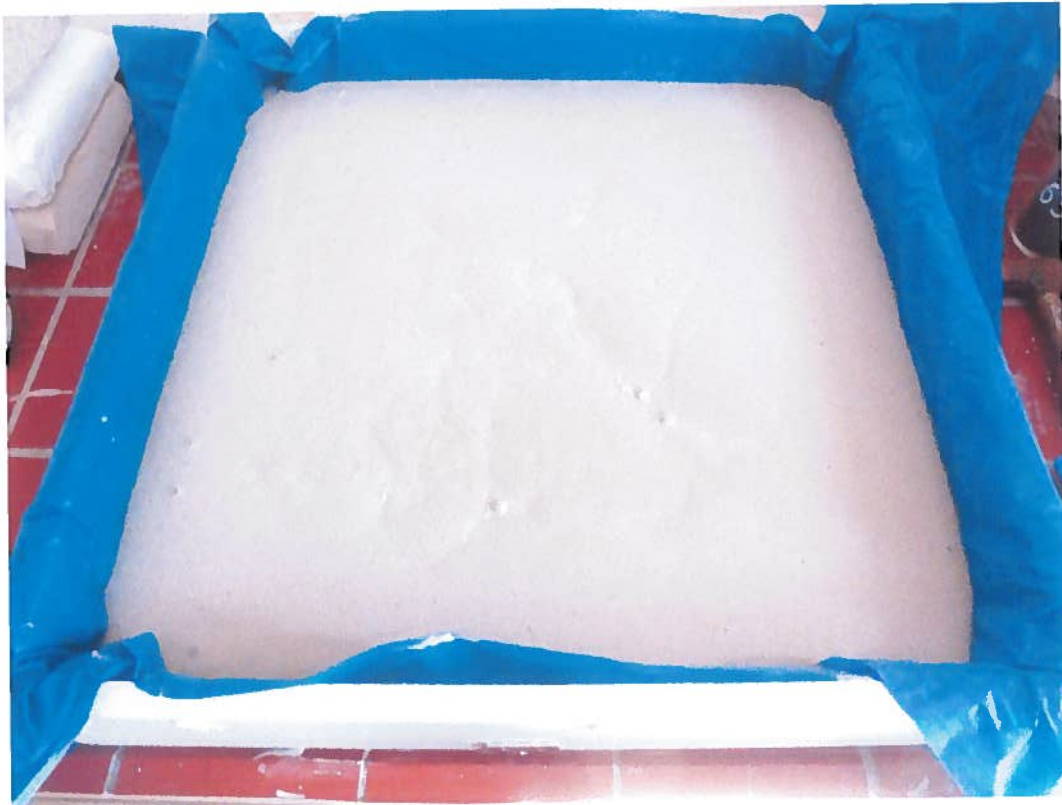
Abbildung K-UTEC 24: Herstellung von Schaumplatten 50 x 50 cm
