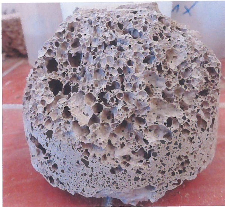
Abbildung K-UTEC 11: BFA-Schaum mit zu viel Wasserstoffperoxid
