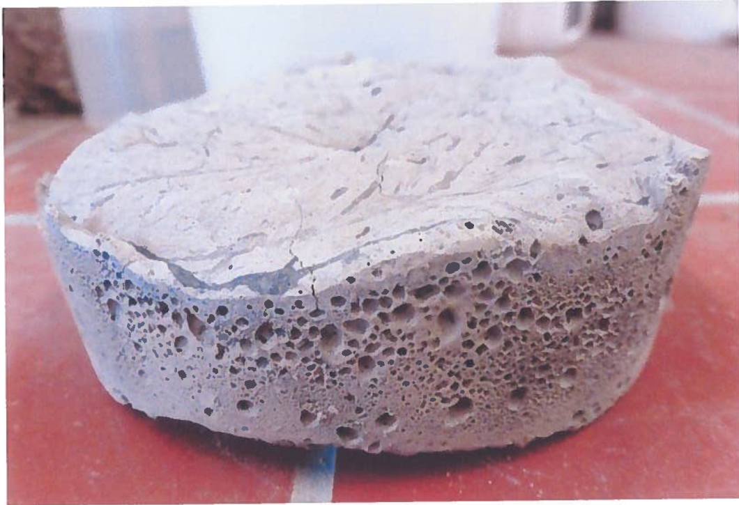
Abbildung K-UTEC 10: BFA-Schaum mit zu wenig Wasserstoffperoxid
