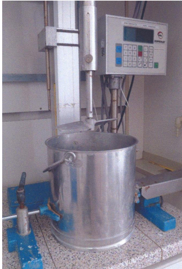
Abbildung 11: Versuchsstand zur Untersuchung der Granulatstabilität in Lösungen
