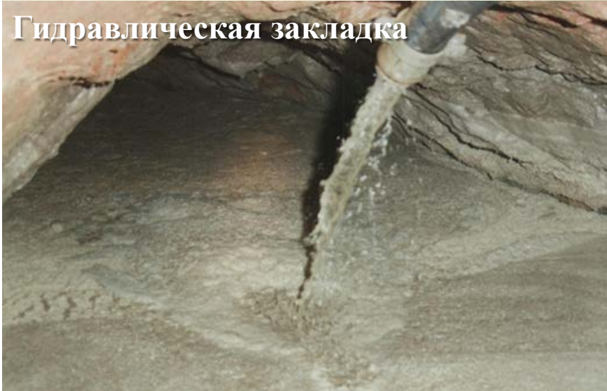
Затвердевшая гидравлическая закладка
