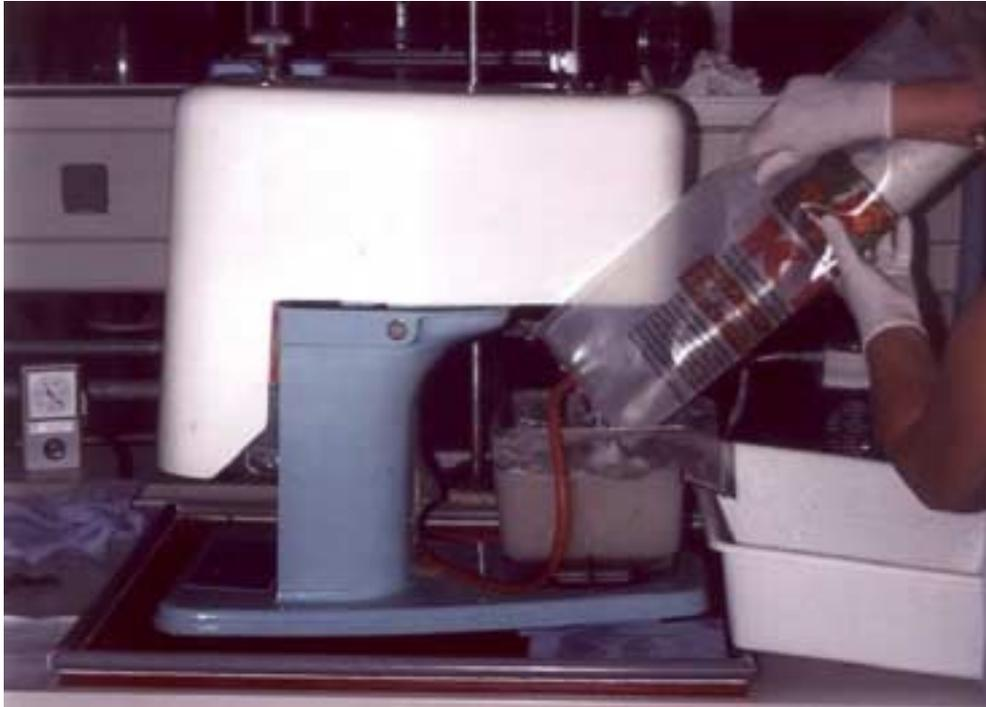
Abb. 3. Einfüllen von 1,5 kg Kristallisatgemisch und anschließend 1 min rühren
