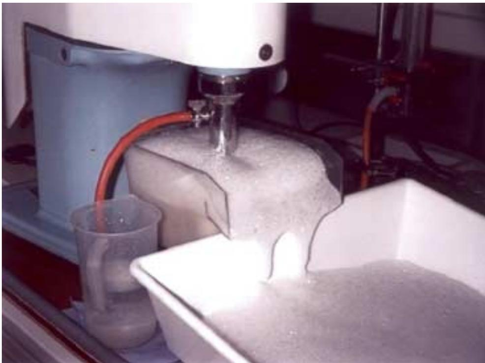
Abb. 6. Überlaufender Schaum nach 1 min Flotation
