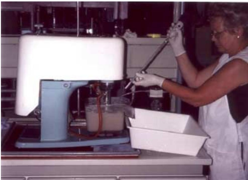
Abb. 4. Zugabe von 14 ml Reagenzlösung und 1min rühren
