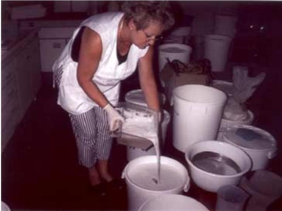
Abb. 9. Ausgießen der Flotationslauge/Carnallit-Suspension in ein Sammelgefäß
