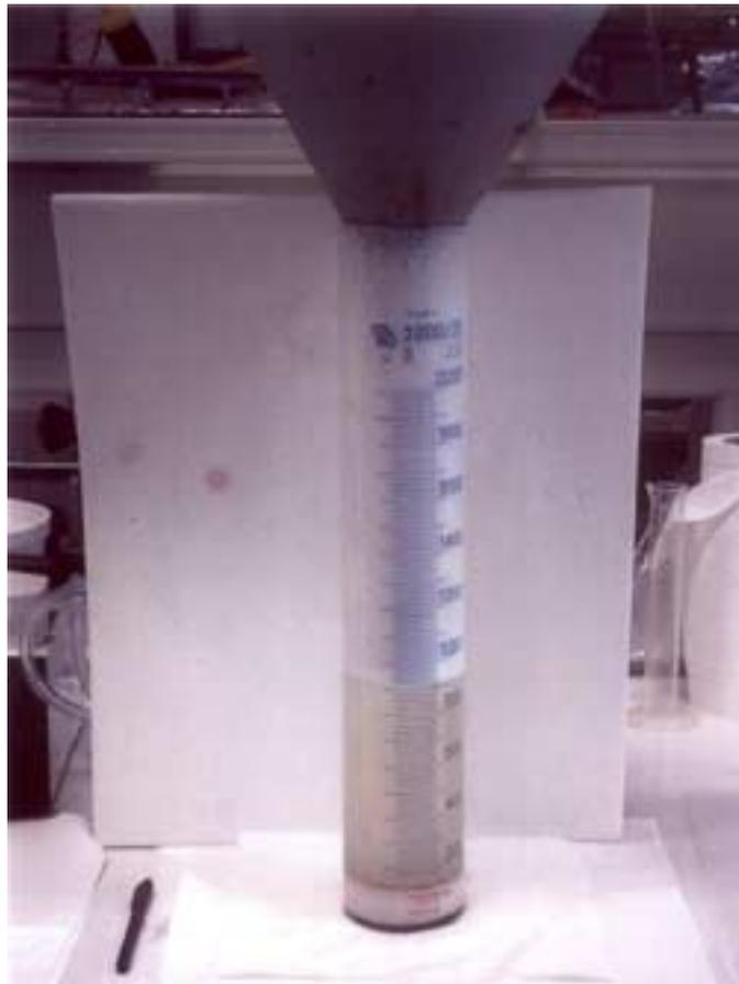
Abb. 11. Klärversuch mit zusammengefallenem Schaum nach 60 min
