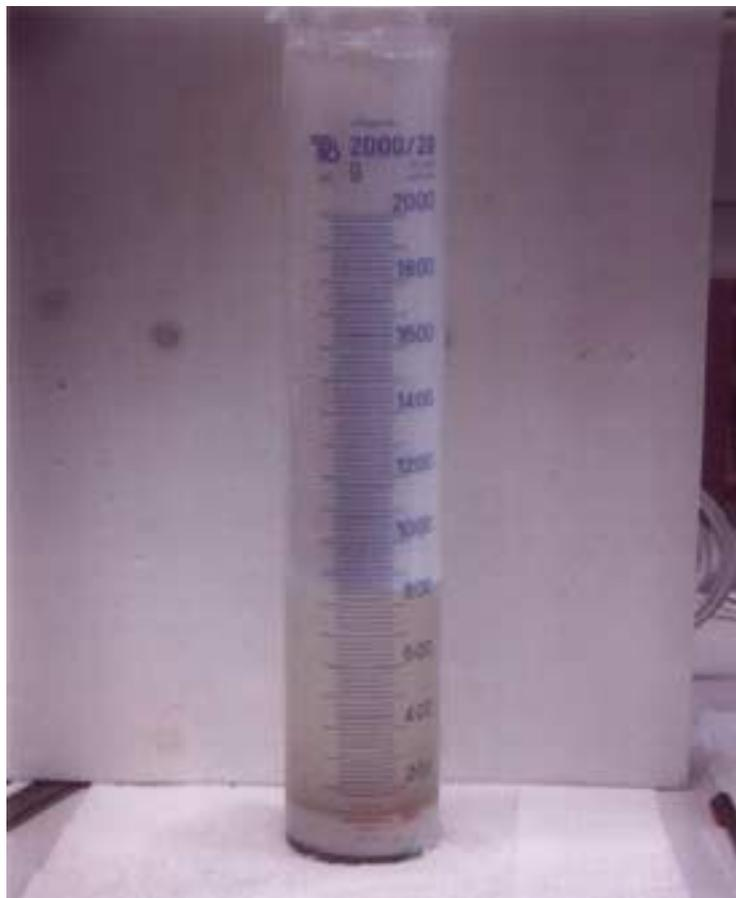
Abb. 10. Klärversuch mit original Schaum nach 90 min
