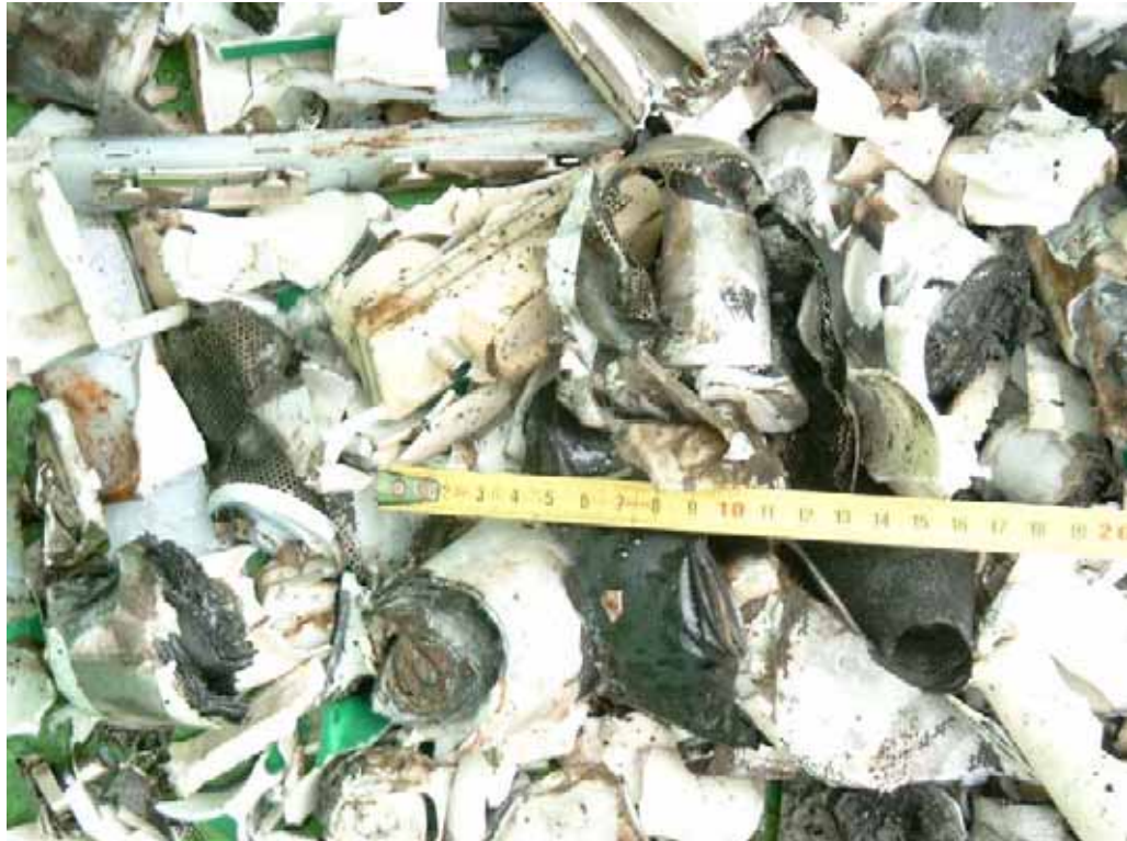
Vorzerkleinerung, Module nach der Vorzerkleinerung
