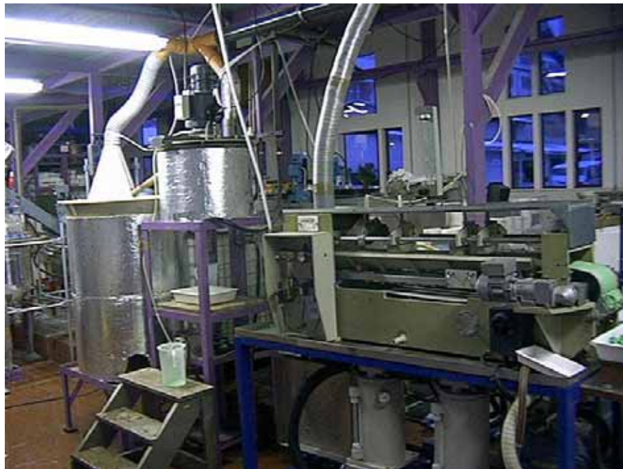
Bild 4: Gesamtansicht der Versuchsanlage mit 100 Liter-Rührreaktor
