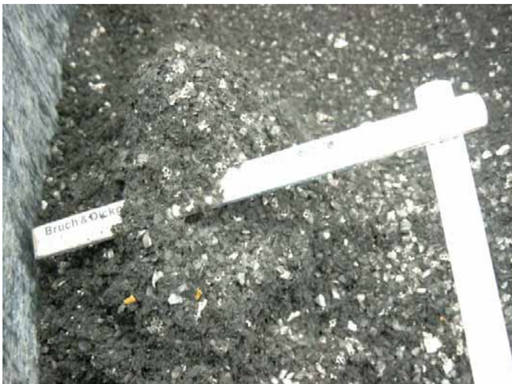
Nachzerkleinerung, Material der mit einem UG 600 MS nach zerkleinerten Module
