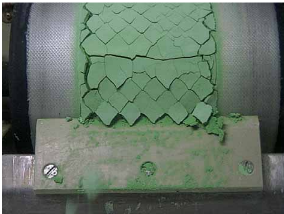
Bild 5: Abwurf des Nickelhydroxids vom Bandfilter
