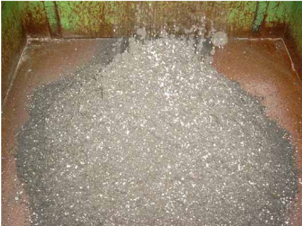
Nachzerkleinerung, Material der mit einem UG 600 MS nach zerkleinerten Rundzellen
