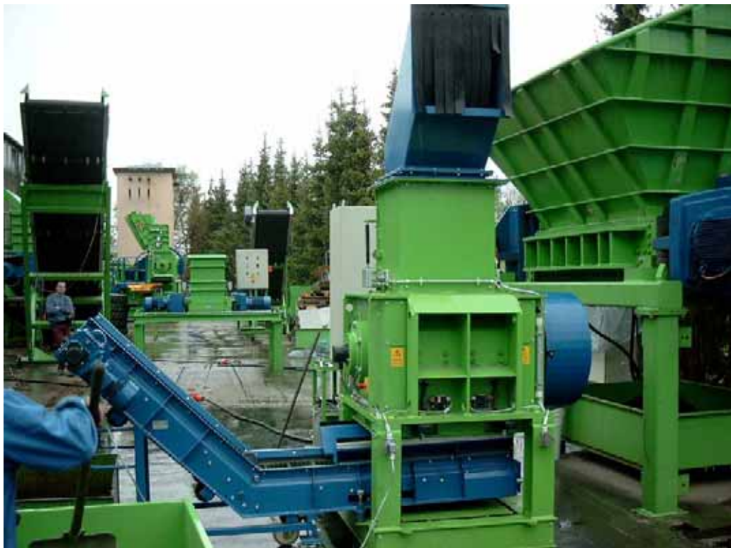
Nachzerkleinerung, UG 600 MS mit Ein- und Austrag
